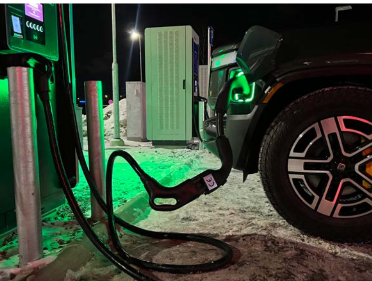
↗ Adapter för CCS-laddare, som tyvärr gör att du måste vända på den otympliga laddkabeln.
